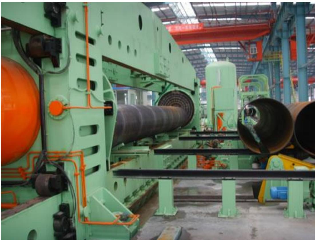
شکل ۲۴-۵ دستگاه آزمایش با فشار آب لوله
