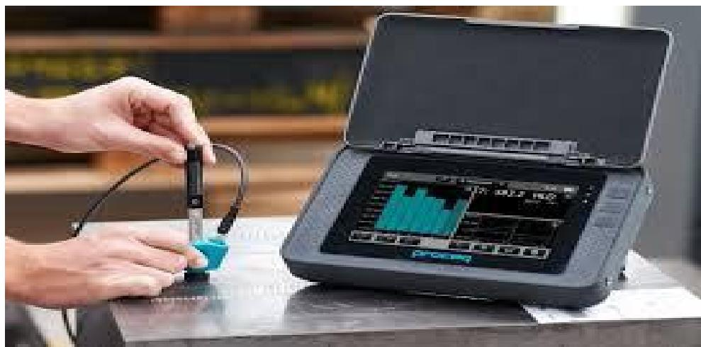
شکل ۱۵-۶ دستگاه آزمایش سختی‌سنج با امواج صوتی
