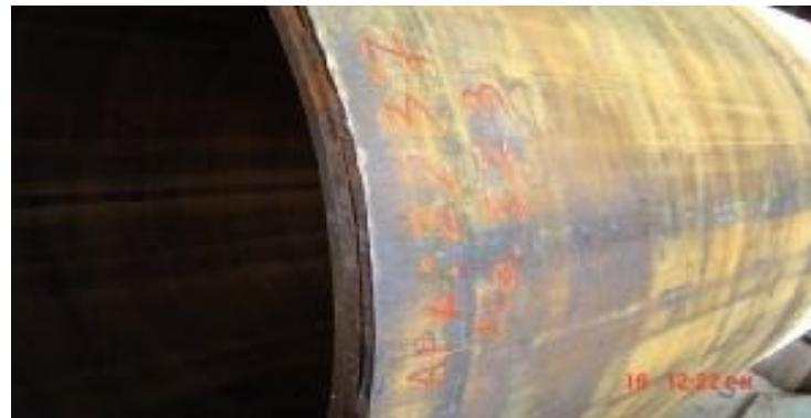
شکل ۳ - ۴ دو پوستگی بر اثر محبوس شدن هوا
