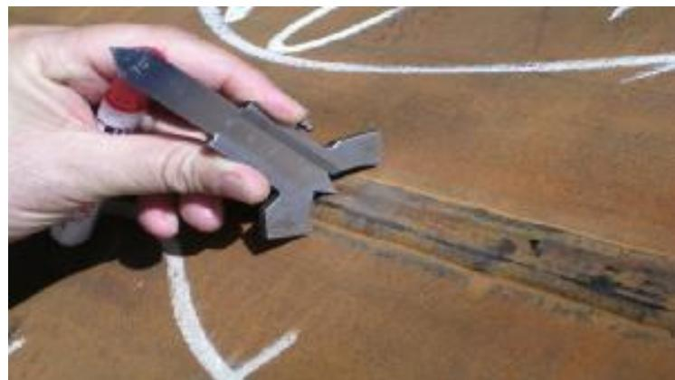
شکل ۱۵-۴ اندازه‌گیری ارتفاع جوش
