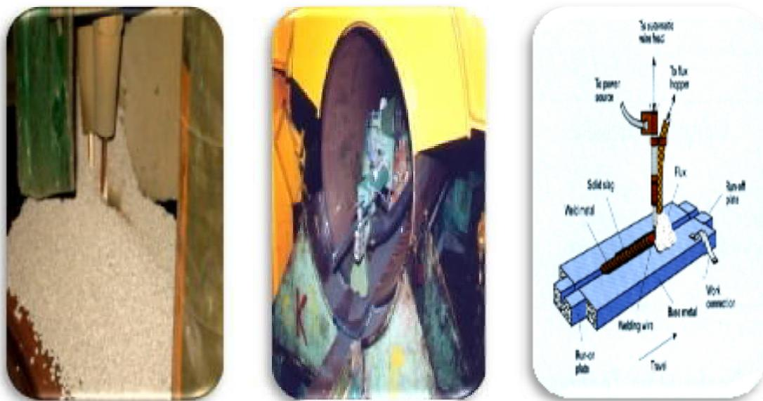
شکل ۴-۳ جوش زیر پودری، داخلی و بیرونی لوله
