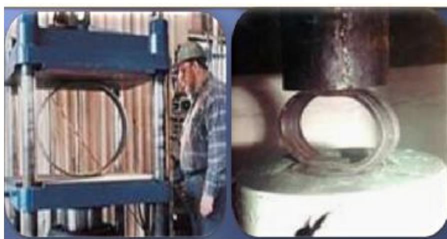
شکل ۷-۶ آزمایش مسطح کردن
