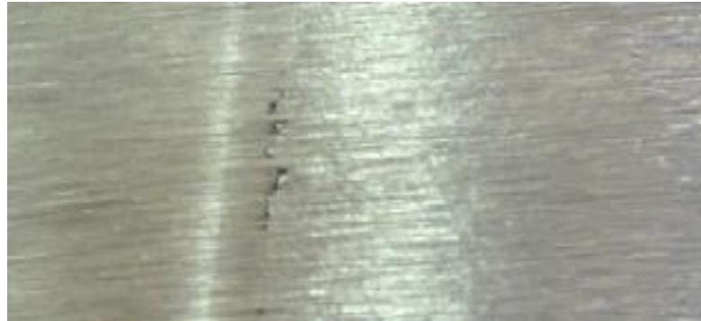
شکل ۱۶-۴ ذوب ناقص بین فلز پایه و جوش
