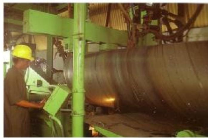
شکل ۱۲-۳ عملیات جوشکاری داخلی و بیرونی درز لوله
