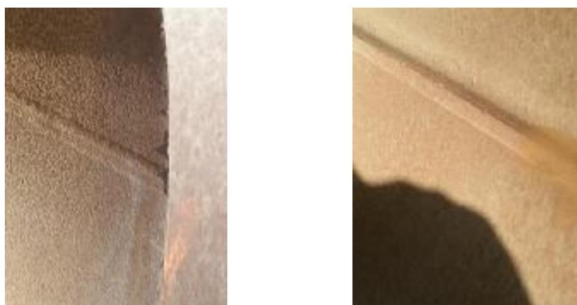
شکل ۴-۲۵ شیار در مرکز جوش
